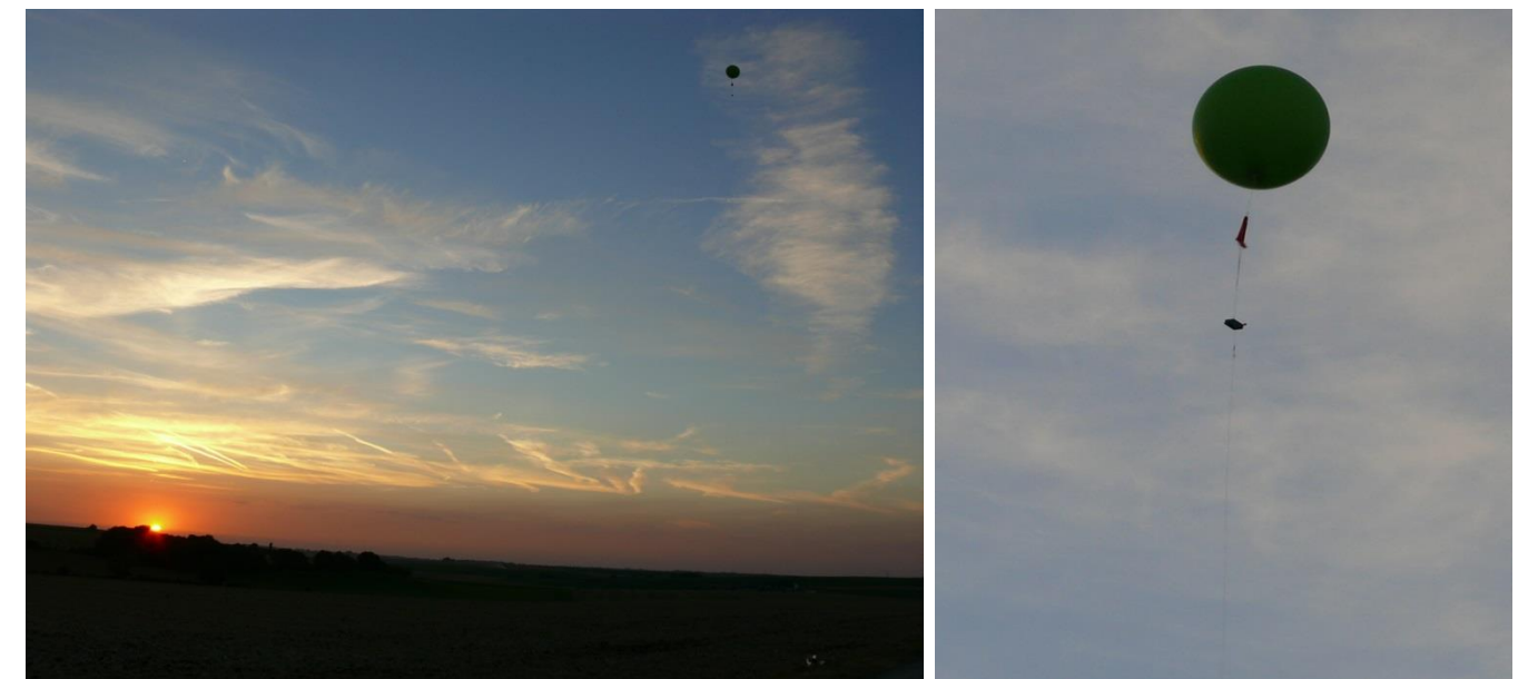
Photographie 1. Ballon captif gonflé, avec micro et ancré au sol
